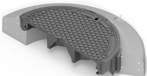
Die Abdeckungen System **NIVROLL** in der Belastungsklasse E600 sind in der Höhe und in der Neigung genau justierbar. Mit allen handelsüblichen Hebeegeräten können die Rahmen auf Belagsoberfläche gezogen werden.
